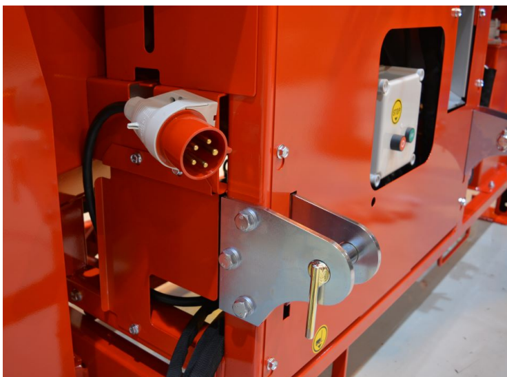
Attēls 10. Elektromotora pieslēgumvieta.
