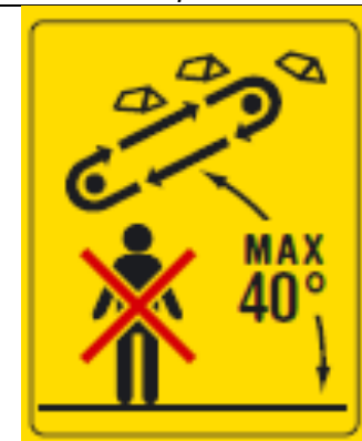
Maksimāli pieļaujamais transportiera slīpums ir 40 grādi. Nestaigājiet zem transportiera!
