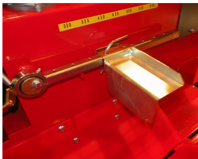
Attēls 18. Ierobežotājplāksnes pozīcija neliela diametra balķiem
