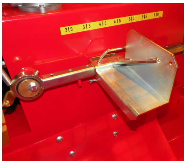
Attēls 17. Ierobežotājplāksnes pozīcija balķiem, kuru diametrs lielāks par 25 cm
