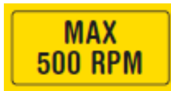
Maksimāli pieļaujamie kardānvārsptas apgriezieni ir 500 apgr./min.
