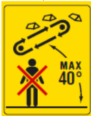
Maksimāli pieļaujamais transportiera slīpums ir 40 grādi. Nestaigājiet zem transportiera!
