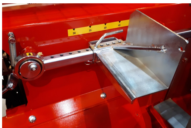
Attēls 15: Mērierīces pozīcija lieliem bluķiem, kuru diametrs pārsniedz 25 cm.
